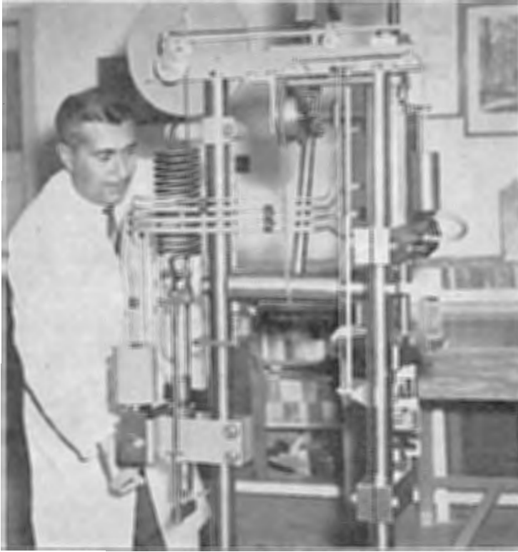
Şekil 4. Odun teknoloji l boratuarında «Amsler» odun dirençlerini  lçme aleti.
